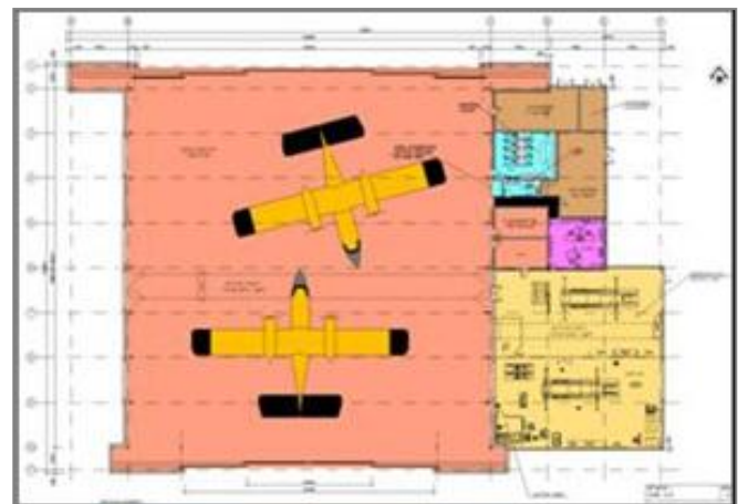
Υπόστεγο αεροσκαφών – Κάτοψη
